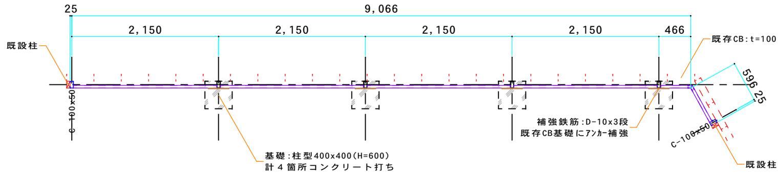
平面図 S=1/20 ※基礎天端はGL-50mmとし、アスファルト舗装仕上げとする
